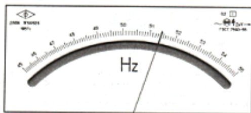
Рисунок 4.4 – Лицевая панель частотомера класса точности 0,2 с номинальной частотой 50 Гц
