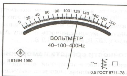
Рисунок 4.2 – Лицевая панель вольтметра класса точности 0,5 с равномерной шкалой
