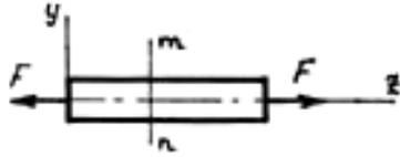
9. Нормальные напряжения  $\sigma$  в поперечных сечениях стержня при растяжении – сжатии определяются по формуле:
