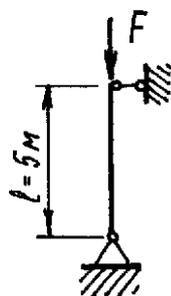
65. Определить допускаемую нагрузку на стальную стойку, если  $A = 50 \text{ см}^2$ ;  $I_{\min} = 436 \text{ см}^4$ ;  $\lambda > \lambda_{\text{пред}}$ . Коэффициент запаса устойчивости  $n_y = 2,5$
