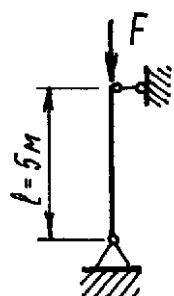
65. Определить допускаемую нагрузку на стальную стойку, если  $A = 50 \text{ cm}^2$ ;  $I_{min} = 436 \text{ cm}^4$ ;  $\lambda > \lambda_{npeo}$ . Коэффициент запаса устойчивости  $n_y = 2,5$
