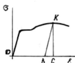
24. Напряжение, при котором происходит рост пластических деформаций образца при практически постоянной нагрузке, называют пределом ... материала.
