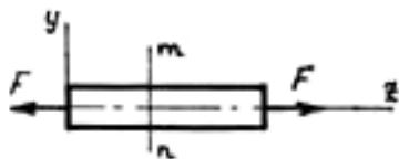
9. Нормальные напряжения  $\sigma$  в поперечных сечениях стержня при растяжении – сжатии определяются по формуле:
