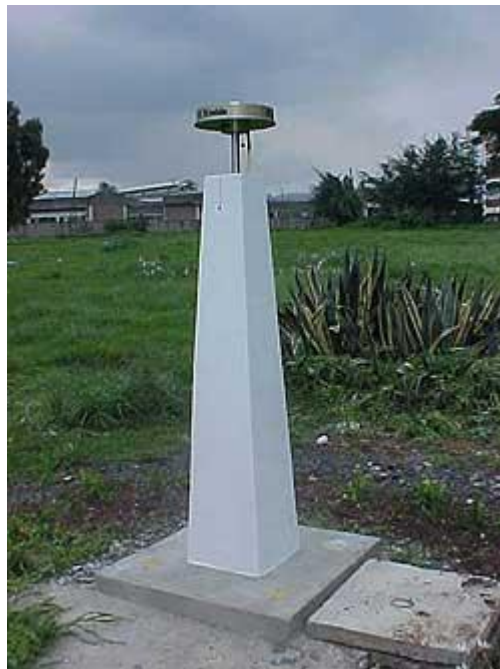
Рисунок 8 – Знак, закрепляющий пункт IGS. Эфиопия (Африка)
